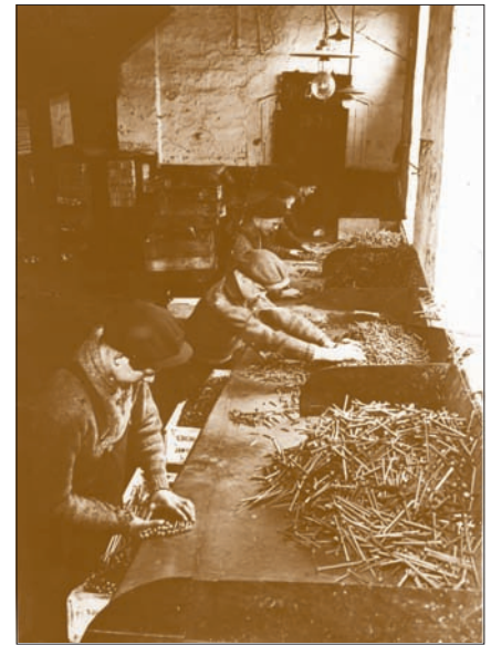
Gutter pakker spiker ved Christiania Spigerverk ved forrige århundreskifte. Christiania Spigerverk baserte til å begynne med hele sin virksomhet på spikerproduksjon fra en maskin som varmsmidde spiker. Den var oppfunnet av engelskmannen Ezra Jenks Coates i 1850, i 1900 konstruerte Victor Anderson automatisk matning av den. I slutten av 1870-åra hadde Christiania Spigerverk 40 slike maskiner.
